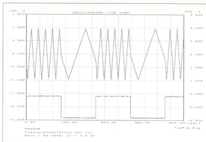
Bild 7. Frequenzmodulation durch ein Rechtecksignal.
